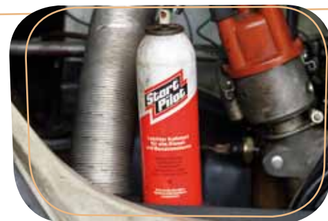
Mit „Startpilot“ sind oft auch ganz schwierige Fälle flott-zubekommen. Man braucht allerdings einen Helfer, der während des Startvorgangs sprüht. Gelegentlich kann es zu Flammenrückschlägen kommen.
