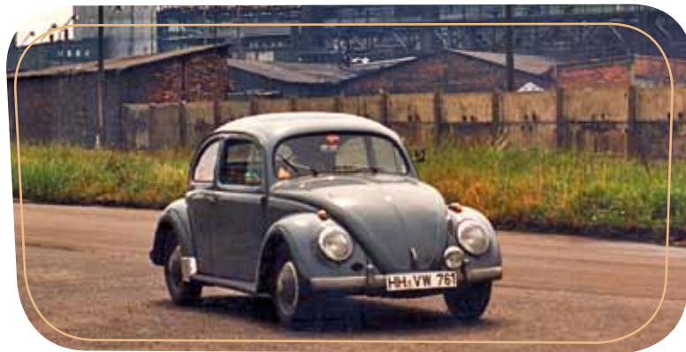
Erst am zweiten Tag wurden sie Freunde: Martin Henze und sein 54er-Standard-Käfer mit unsynchronisiertem Getriebe und Seilzugbremsen
