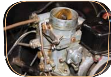
Hier ein 30-PS-Käfermotor mit Solex-28-PCI-Vergaser und Handchoke (geöffnet). Gut zu sehen: das Flatterventil in der Kaltstartklappe, das den Luftdurchlass beim Gasgeben erleichtert.
