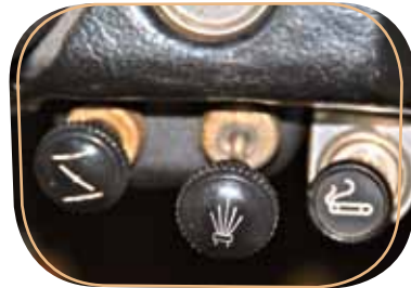
Der gezogene Chokezug bei einem Alfa Romeo Spider ist mit einem etwas irreführenden „Einspritzsymbol“ gekennzeichnet. Links daneben: ein weiterer Zug für Handgas, der auf denselben Mechanismus wie das Gaspedal wirkt
