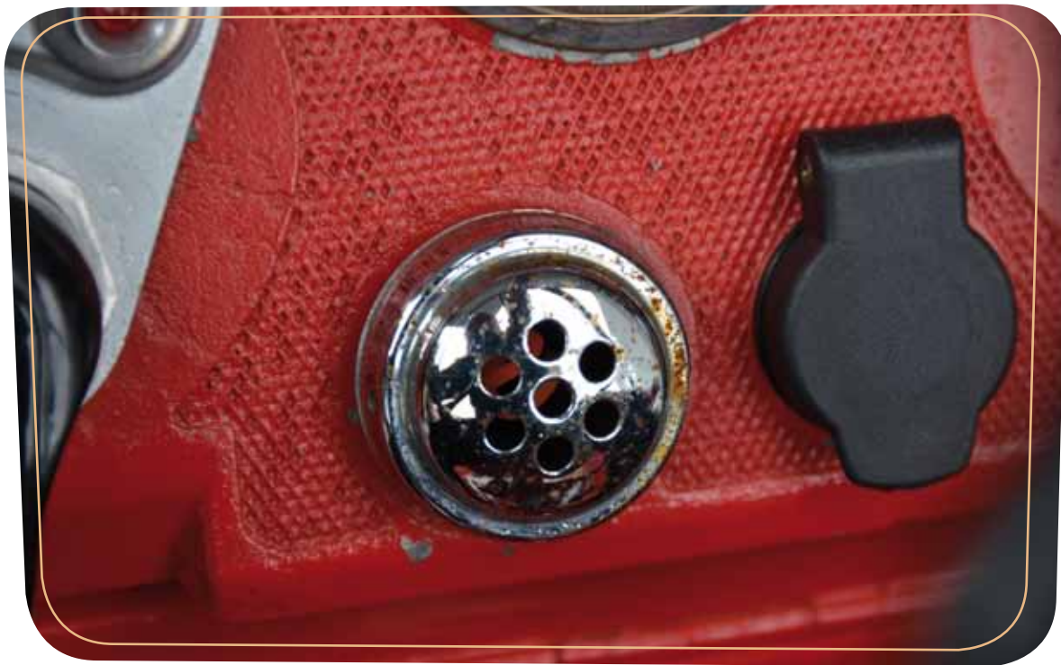
Rudolf-Diesel-Gedenkminute: Hinter dem „Salzstreuer“ (unten im Bild eines Porsche-Traktor-Armaturenbretts) haben ältere Dieselmotoren eine Glühkerze zur Vorglühkontrolle
