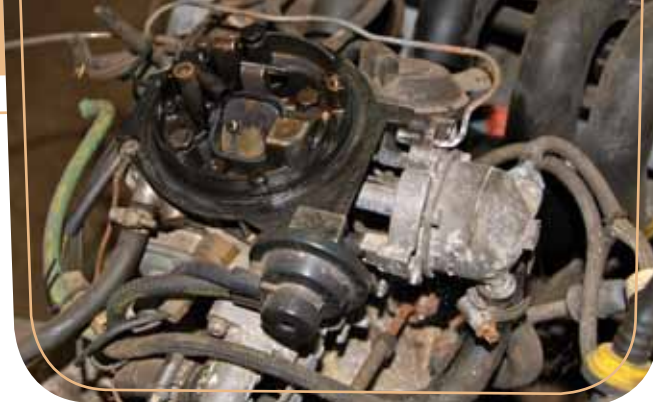
Moderner Registervergaser mit kühlwasserbeheizter Startautomatik (rechts im Bild das Heizelement mit dünnen Wasserschläuchen an einem Golf-II-Motor). Ungefähr in der Bildmitte ist die Kaltstartklappe zu erkennen.
