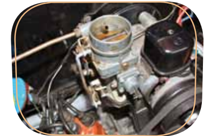
Beim Kaltstart wird der Chokezug gezogen. Dadurch schließt sich die Kaltstartklappe, das Kraftstoff-Luft-Gemisch wird „fetter“, was die Zündfähigkeit verbessert.
